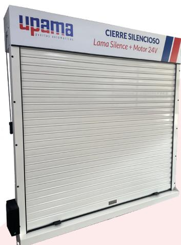
La lama **P-77 Silence** consiste en el ensamblado de dos láminas de acero mediante un polímero intermedio de dos caras. Dicho polímero absorbe la transmisión de vibraciones de los perfiles metálicos, consiguiendo reducir hasta un **80% de sonoridad** con respecto a las lamas tradicionales; dando así la solución a los clientes que requieren un sistema de seguridad silencioso.
